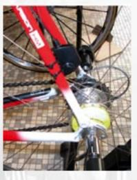
Attacher à l'aide de ruban adhésif le câble de transmission tout au long du cadre jusqu'à la potence
