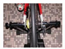
Le cran du rouleau verrouillé, fixer le vélo en vissant les vis et contre écrous de fixation de chaque côté.
